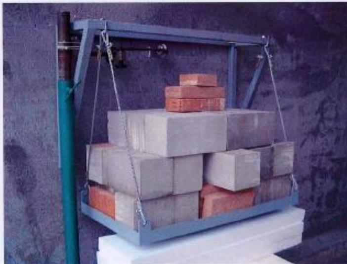
Foto 4: L'applicazione del carico verticale eccentrico da 4000 N
